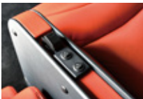
パーテーション・昇降SW、間接照明用・SW(天井、床部)
